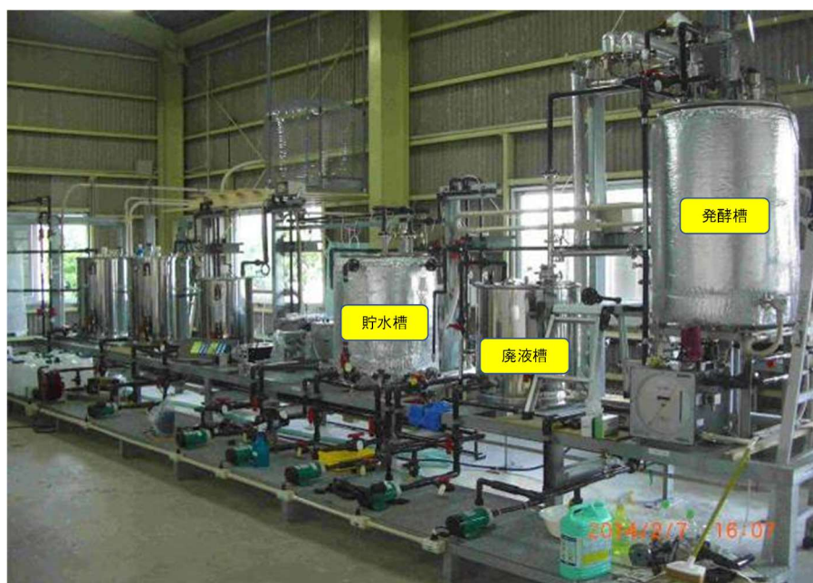
図 3. 糖蜜を原料とする水素発酵パイロットプラント。
